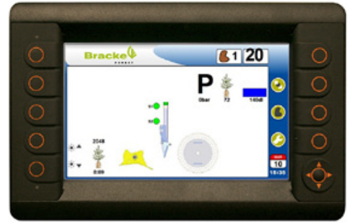
PLC-pohjainen, CAN-bus-tekniikkaa käyttävä Bracke Growth Control -ohjaujärjestelmä
