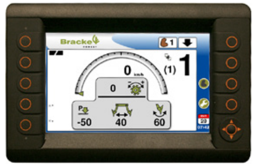
PLC-pohjainen, CAN-bus-tekniikkaa käyttävä Bracke Growth Control -ohjausjärjestelmä
